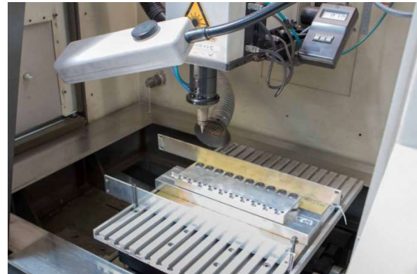
Image 5: Perçage dans l'installation laser
