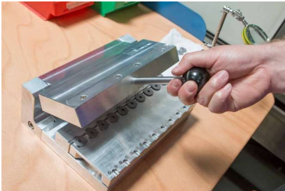
Image 4: Centrage des pièces pour l'usinage
