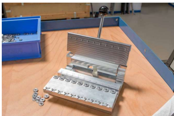
Image 1: Dispositif de centrage avec le porte-pièces
