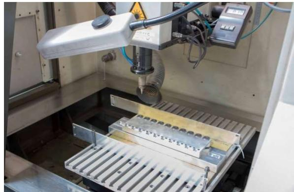
*Bild 5: Bohren in der Laseranlage*
