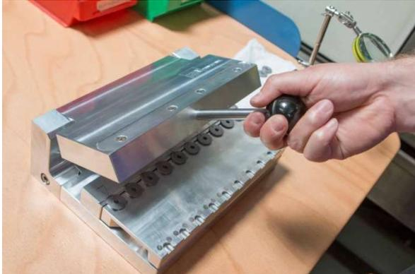
*Bild 4: Zentrierung der Werkstücke für die Bearbeitung*
