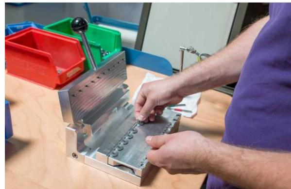
Bild 2: Einlegen der Werkstücke auf die Halterung
