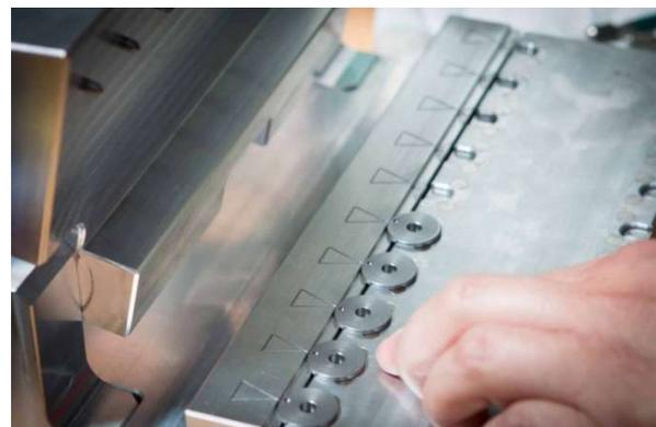
Bild 3: Positionierung der Werkstücke auf die Halterung
