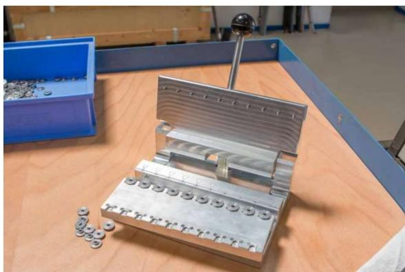
Bild1: Zentriervorrichtung mit Werkstücktray
