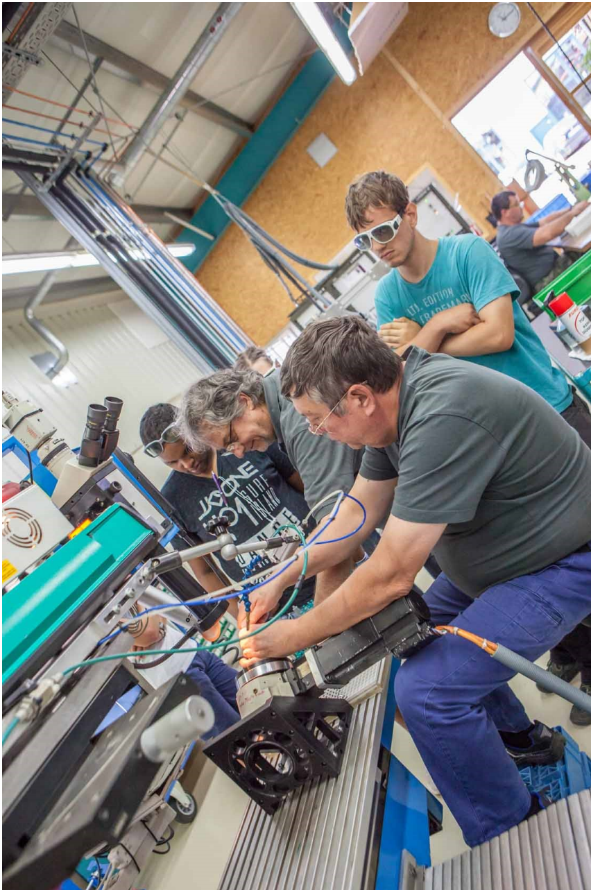
Bild2: Schweißen von Endoskop-Grundkörpern
