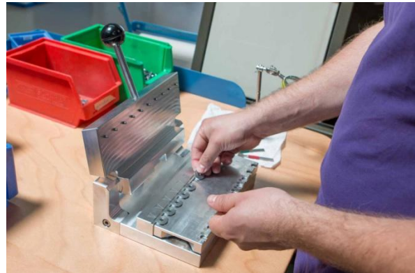
Bild 2: Einlegen der Werkstücke auf die Halterung
