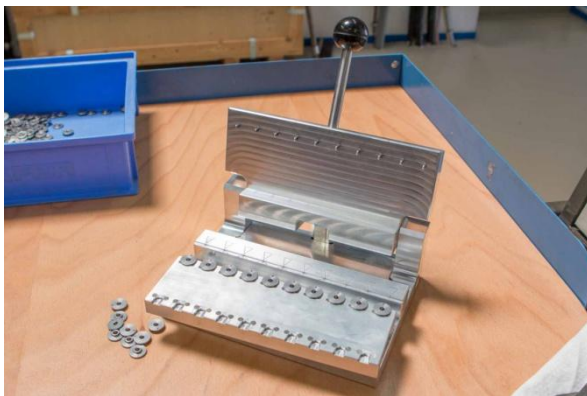
Bild 1: Zentriervorrichtung mit Werkstücktray
