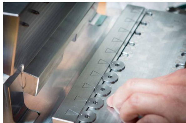
Bild 3: Positionierung der Werkstücke auf die Halterung
