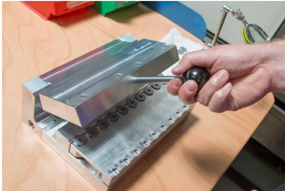
Bild 4: Zentrierung der Werkstücke für die Bearbeitung
