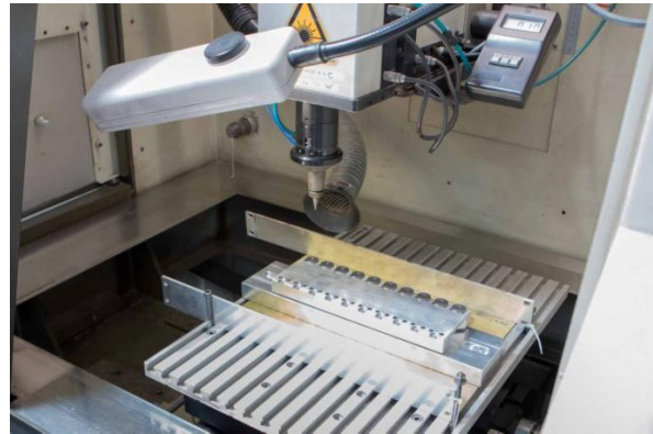
Bild 5: Bohren in der Laseranlage
